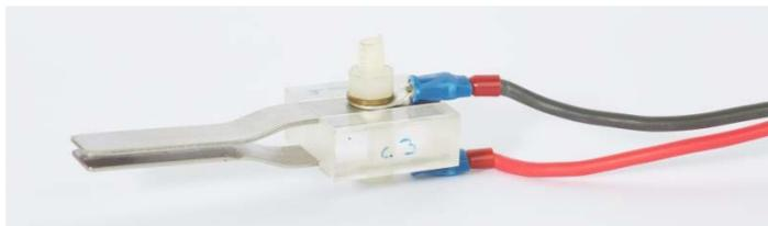
*Slika 8: Jeklene paralelne elektrode, ki so bile uporabljene v poskusih. Med elektrode smo prenesli kapljico celične suspenzije ter jo izpostavili električnim pulzom.*
