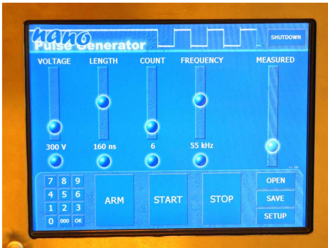
Slika 3.2 Grafični uporabniški vmesnik na zaslonu občutljivem na dotik, s katerim kontroliramo delovanje verzije generatorja kratkih visokonapetostih pulzov.
