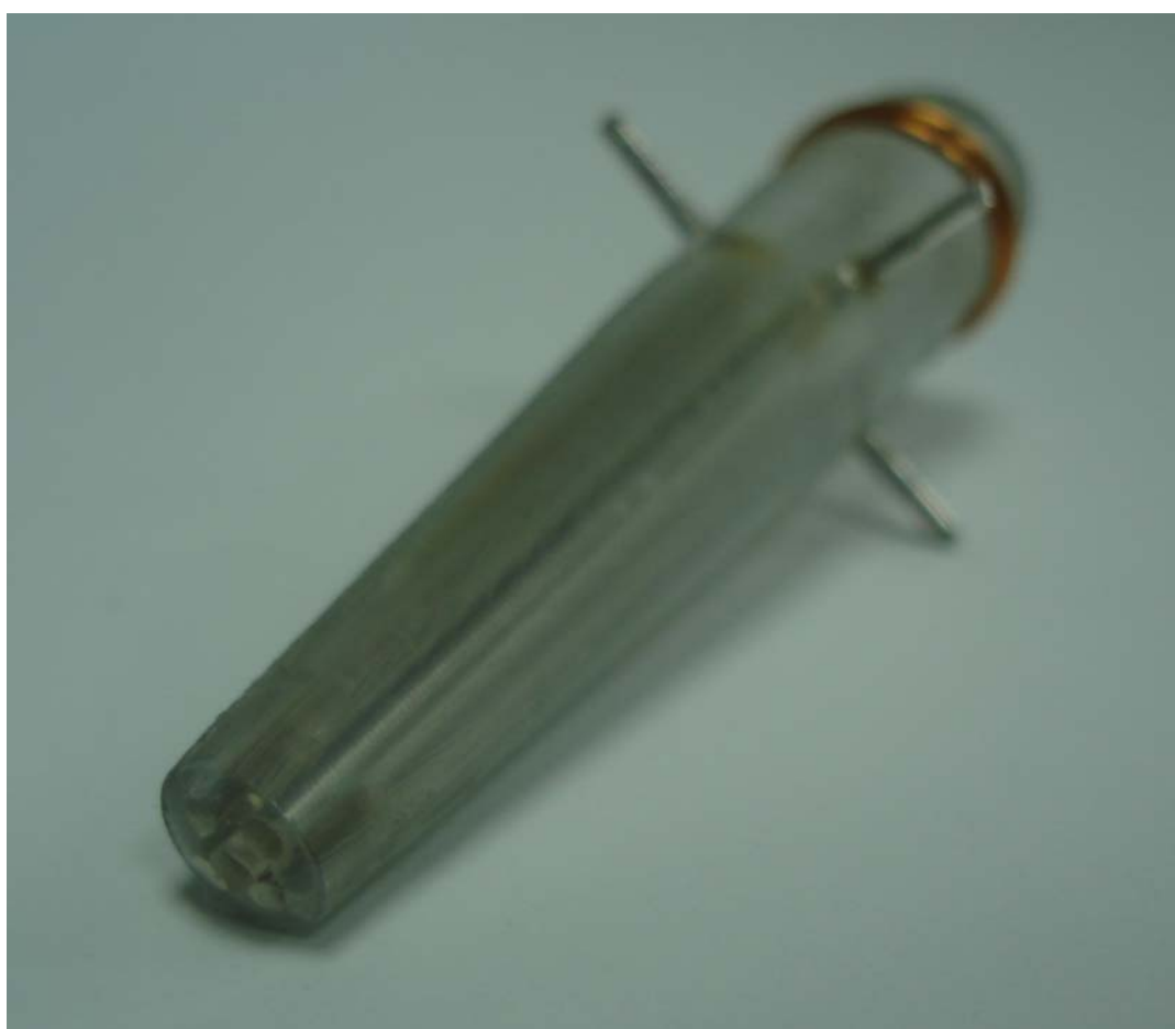
Slika 4.3 Koničasta komora z vgrajenimi elektrodami.
