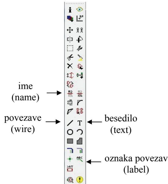
Vežalni načrt vezja lahko naredite v istem oknu. Izberite knjižnico "ic-package" in iz nje ustrezna ohišja integriranih vezij. Zgoraj prikazani simbolni načrt vezja lahko realiziramo z dvema integriranimi vezji: negatorjem (DIL 16) in NOR vrati (DIL 14). Priključke integriranih vezij povežemo, dodamo še ustrezne linije za vhodne in izhodne signale ter napajanje in maso. Končni simbolni in vežalni načrt vezja izgledata takole:
