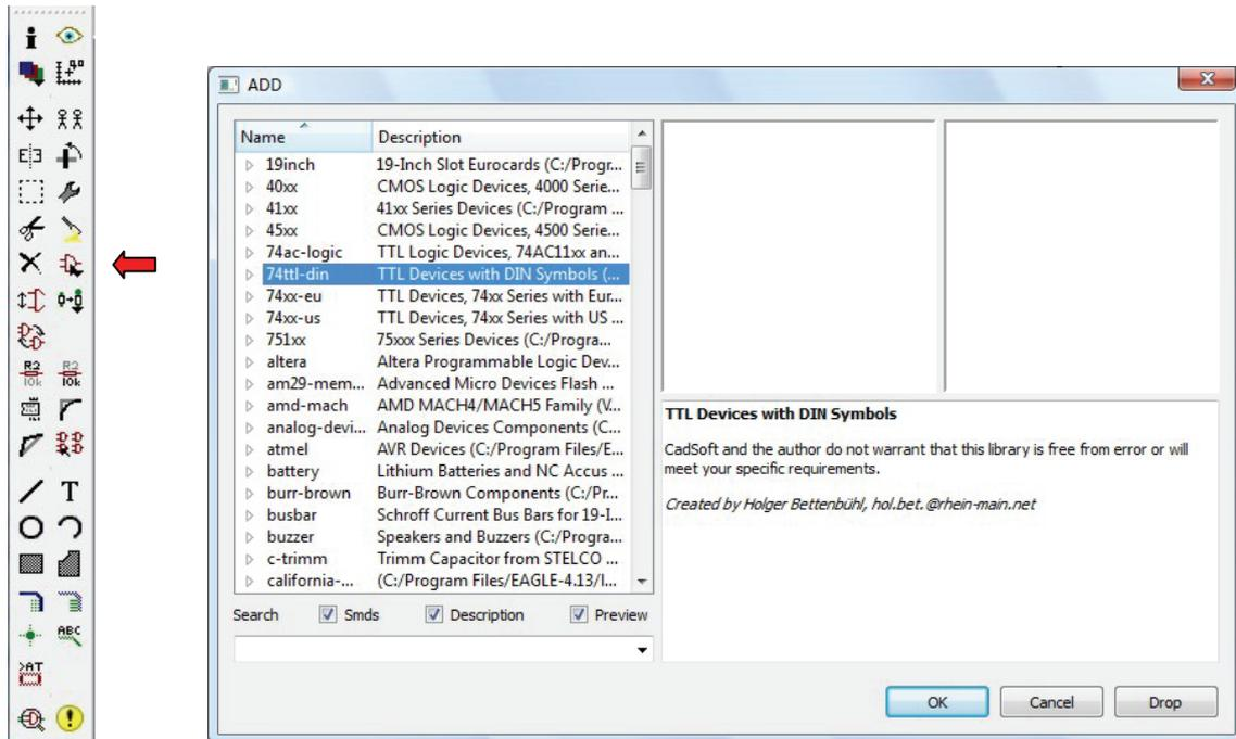
Levi del okna knjižnice vsebuje imena in opis posameznih elementov, desni del okna pa predogled simbolov in ohišja elementov. Simbole za logična vrata, ki so najbližje standardu IEC, najdete v knjižnici 74ttl-din. Če npr. želite poiskati element 7402 (2-vhodna NOR vrata), odprete knjižnico 74ttl-din in izberete element 7402N.
