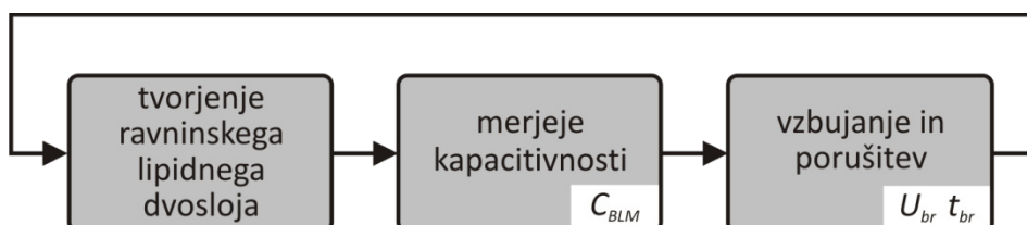
Slika 9. Merilni protokol. Tvorimo ravninski lipidni dvosloj ter izmerimo kapacitivnost C_{BLM} . Podatek o kapacitivnosti odloči, ali je meritev upoštevana v analizi. Na ravninski lipidni dvosloj pritisnemo napetost, ter opazujemo tok. Ob porušitvi ravninskega lipidnega dvosloja tok naraste; odčitamo porušitveno napetost U_{br} in življenjski čas t_{br} ravninskega lipidnega dvosloja.
