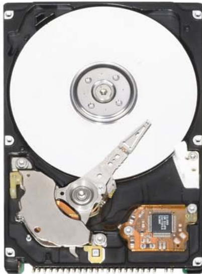
klasični trdi disk z magnetnim zapisom ( angl. hard disk drive - HDD )
